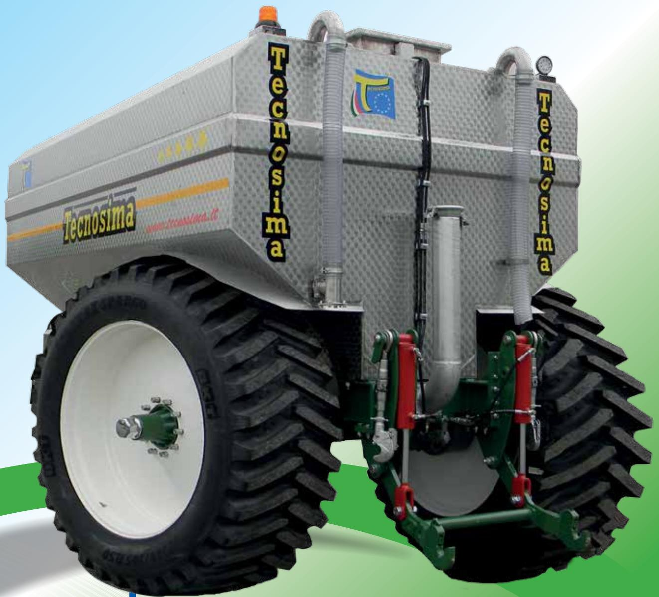
**Sistema posteriore a sollevamento intercambiabile con molteplici soluzioni di distribuzione ad ancore fisse, ancore oscillanti, indipendenti barre di distribuzione in superficie 12-16 mt ed altre tipologie di spargimento.**
